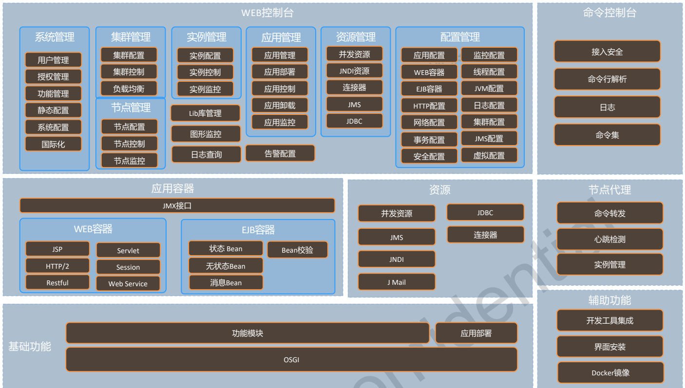
图2 FlyingServer整体功能架构
